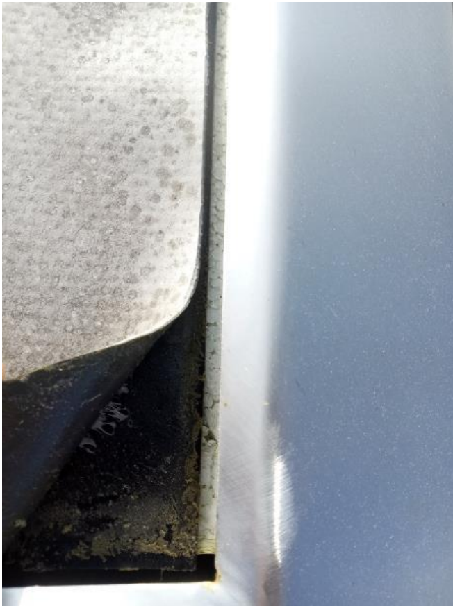
Abbildung 31 Schichtaufbau Foliendachlysimeter (eigene Aufnahme, 2019)
